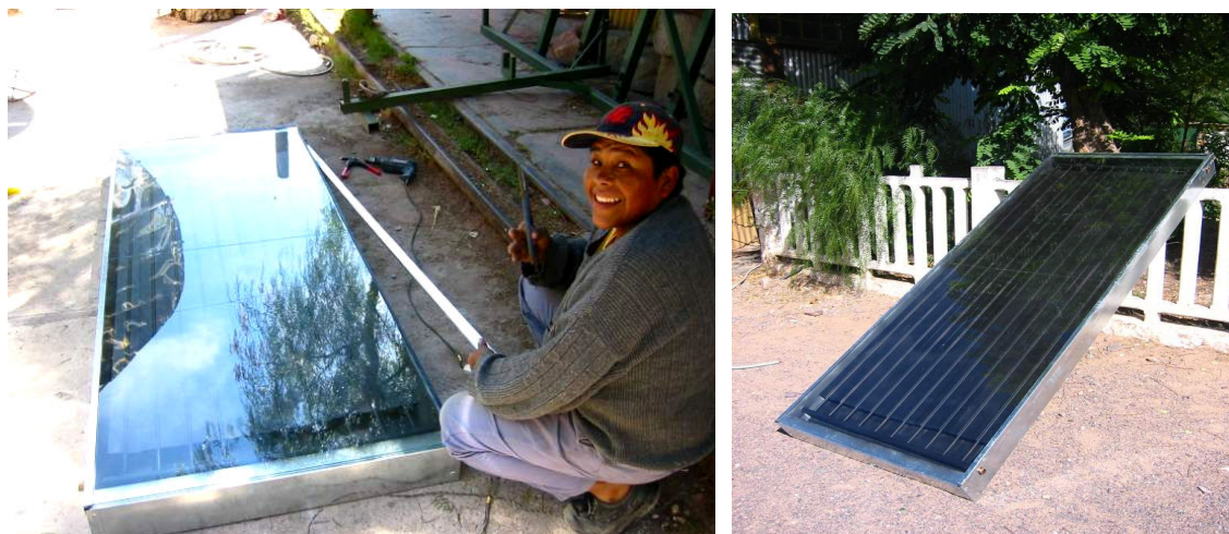
Figura 6: Colectores solares de agua caliente, contruidos por la cooperativa PIRCA/Tilcara
