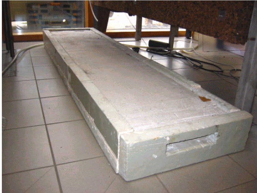
Abbildung 4-18: Teststand für die Hypokaustenheizung
