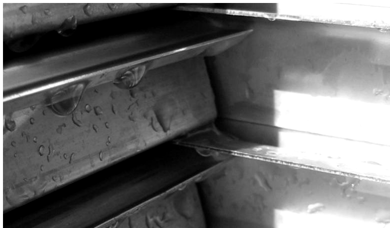
Abb. 11-7: Ableitbleche zur Verhinderung der Verluste
