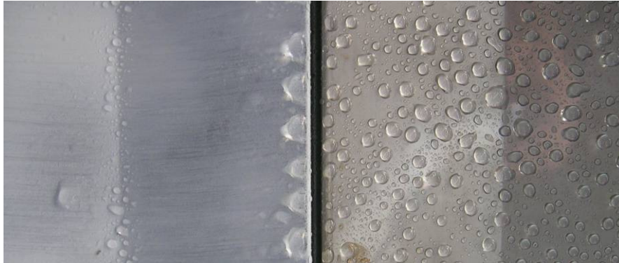
Abb. 11-5: Benetzung auf unterschiedlich behandelten Oberflächen (links Acrylgrundierung, rechts Edelstahl unbehandelt)
