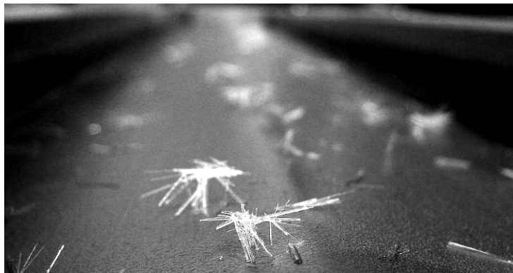
Abb. 13-8: CaSO 4 -Kristalle und CaCO 3 Ablagerungen nach 6-wöchigem Betrieb bei f=1,2
