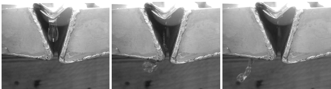
Abb. 11-6: Destillatverlust durch Ablenkung abfließender Tropfen
