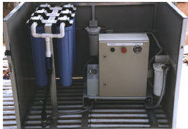
Abb. 2-9: Solarbetriebene Umkehrosmoseanlage mit einer Tagesleistung von 1m 3 /d in Australien
