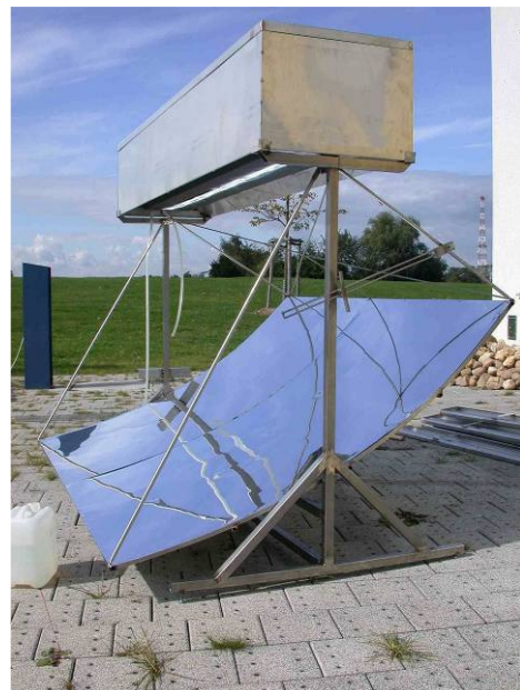
Abb. 13-6: Schnitt durch Prototyp mit Ost-West-Parabolrinne und Anlage in Betrieb
