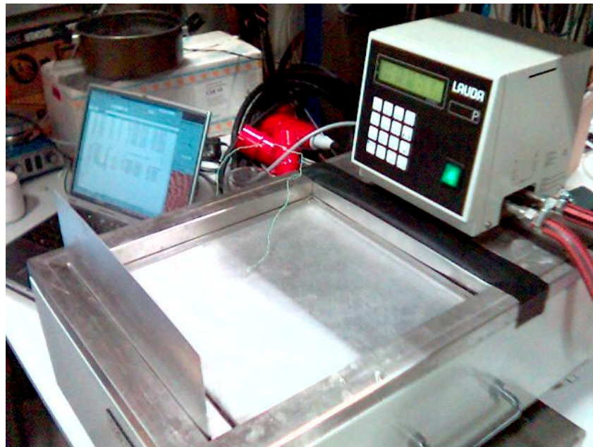
Abb. 6-3: Versuchsaufbau: Verdampfung aus dünnen Wasserschichten
