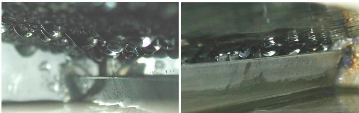
Abb. 4-4: Tropfenkondensation an Beckenunterseite Abb. 4-5: Filmkondensation an Beckenunterseite
